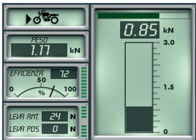
EFFICIENZA FRENANTE. Esecuzione prova su freno anteriore.
