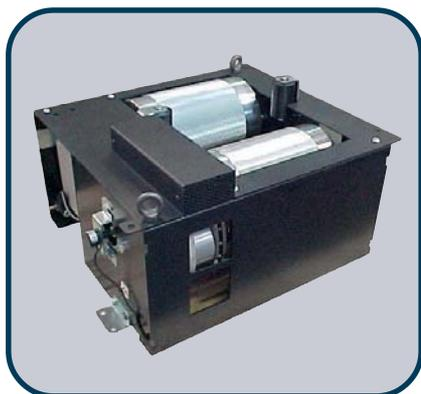
Banco PROVA VELOCITA' max. per motocicli e ciclomotori a due ruote.
