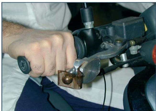
Trasduttore di forza (dinamometro) applicato sulla leva di comando del freno anteriore.
