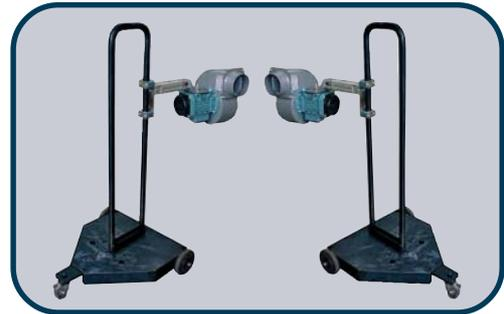
Coppia ventole di raffreddamento motore, contrapposte, montate su carrello di supporto.
