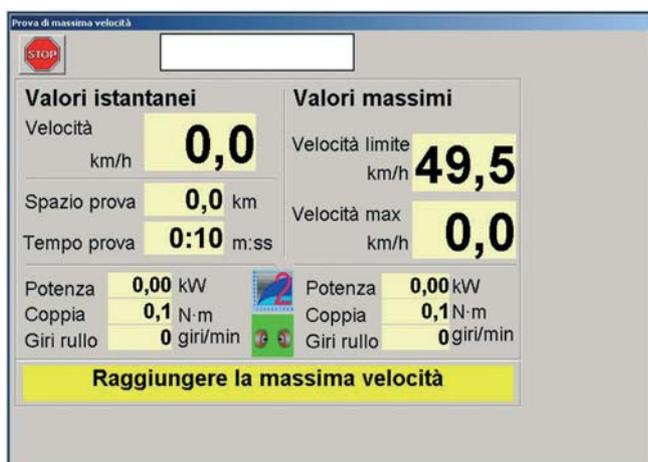
Programma PROVA VELOCITA'. Misura della velocità massima di motocicli e ciclomotori e test gas motori a due e quattro tempi.
