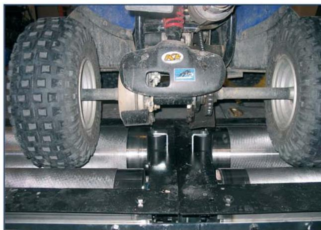
PROVA VELOCITA'. Dettaglio "Quad" su blocco rulli durante l'esecuzione della prova.
