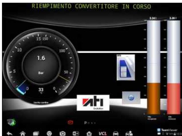
ATI EVOLUTION inizierà a sostituire l'olio presente all'interno del convertitore. La fase sarà svolta svuotando 100 grammi di olio esausto e immettendo 100 grammi di olio nuovo alla volta fino alla sostituzione completa della quantità impostata precedentemente.
