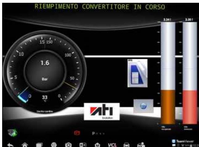
Ati Evolution inizierà a sostituire l'olio nel convertitore indicando la quantità di olio immesso e la quantità di olio recuperato.
