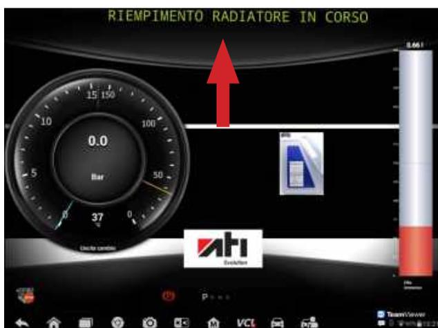
ATI EVOLUTION procederà al riempimento del radiatore effettuando un flussaggio dell'impianto di raffreddamento. L'olio esausto verrà fatto precipitare nella vasca di raccolta olio posizionata sotto il gruppo idraulico.
