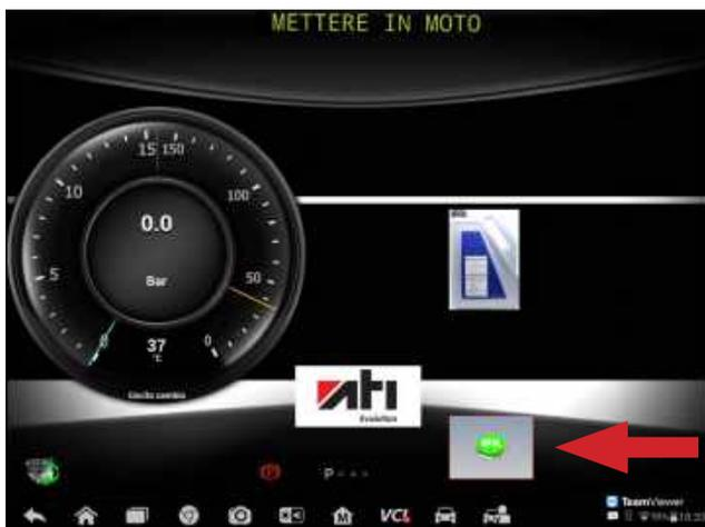
Terminata la fase di riempimento della coppa accendere il motore per iniziare la fase di sostituzione dell'olio nel convertitore premere il tasto OK dopo aver acceso il motore.
