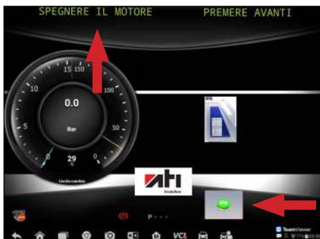
Dopo aver spento il motore premere il tasto OK (se richiesto dal tipo di trasmissione - altrimenti questa fase verrà saltata e la procedura ripartirà in maniera automatica dalla procedura di sostituzione olio convertitore).
