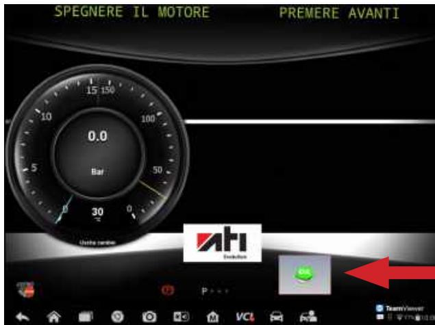
Dopo aver acceso il motore premere il tasto "OK", la ATI EVOLUTION riconoscerà il corretto senso del flusso dell'olio.
