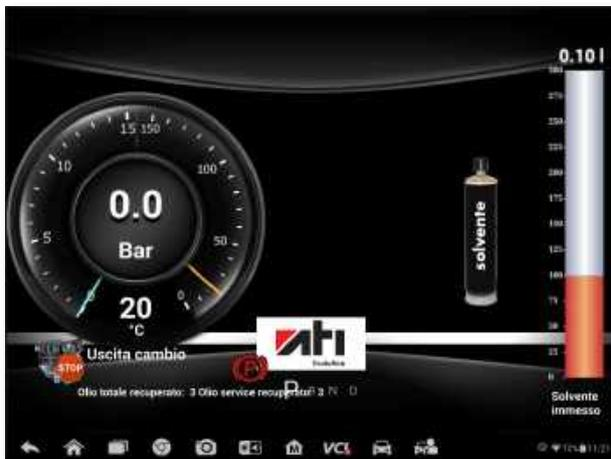
Se viene spuntata l'operazione di immissione solvente, ATI EVOLUTION procederà all'immissione della quantità impostata.
