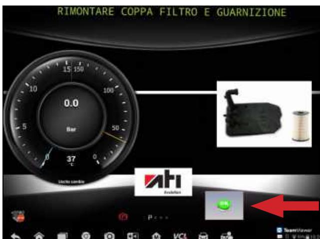
Una volta terminata la procedura di riempimento radiatore, procedere con il rimontaggio di coppa, filtro e guarnizione.
