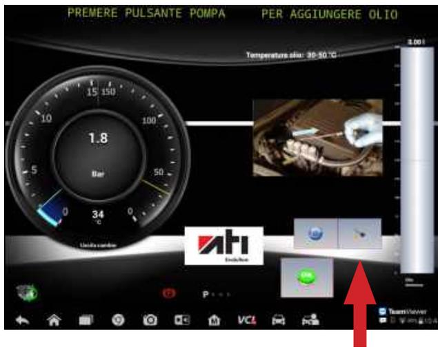
Procedere alla verifica del corretto livello olio, se il livello risultasse insufficiente agire sul tasto POMPA per iniziare ad aggiungere olio sino alla quantità corretta. Terminata l'operazione di ripristino livello spegnere il motore.
