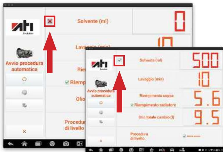
Per autorizzare l'immissione del solvente attivare la spunta, in modo automatico apparirà la quantità necessaria per effettuare l'operazione.
