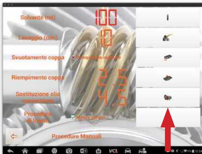
Agendo sul tasto "SOSTITUZIONE OLIO CONVERTITORE" si avvia la fase di sostituzione dell'olio esausto presente nel convertitore attraverso l'immissione della stessa quantità di olio nuovo.
