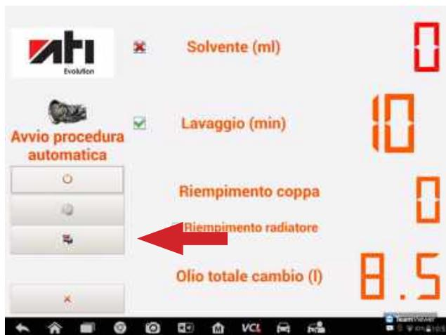
Una volta terminata l'operazione premendo il tasto stampa è possibile procedere alla stampa del report di tutte le operazioni effettuate.
