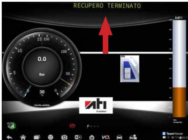
Al termine dello svuotamento della coppa ATI EVOLUTION avviserà di aver terminato la fase (se richiesto dal tipo di trasmissione - altrimenti questa fase verrà saltata e la procedura ripartirà in maniera automatica dalla procedura di sostituzione olio convertitore) richiedendo di spegnere il motore.
