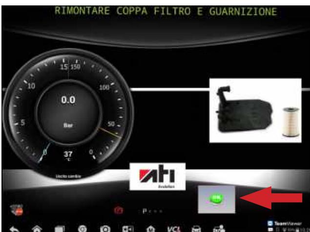
Al termine del flussaggio rimontare il filtro nuovo con la guarnizione (se richiesto dal tipo di trasmissione - altrimenti questa fase verrà saltata e la procedura ripartirà in maniera automatica dalla procedura di sostituzione olio convertitore).
