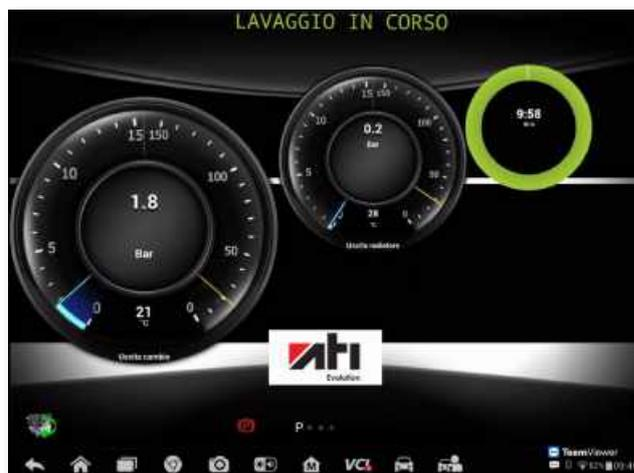
Al termine della procedura di lavaggio della trasmissione automatica, ATI EVOLUTION procede allo svuotamento della coppa (se richiesto dal tipo di trasmissione - altrimenti questa fase verrà saltata e la procedura ripartirà in maniera automatica dalla fase di sostituzione olio convertitore).
