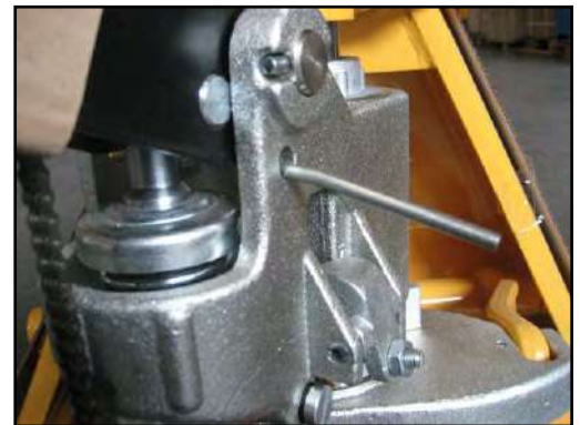
Figura 9 – Sfilare il fermo.
