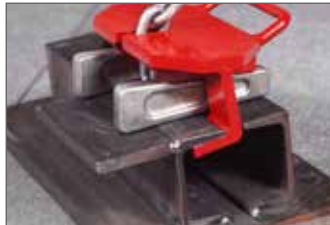
HD8301+2 X K238320 Ancoraggio della catena 20 T per telaio Korek®
