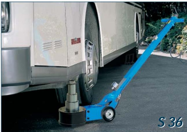
**S 36** è stremamente robusto e potente, è soprattutto adatto a lavori estremi su mezzi pesanti. Il sistema di sollevamento è del tipo a cilindri verticali multistadio. L'escursione di sollevamento va da 175 mm a 560 mm (con prolunghe).
