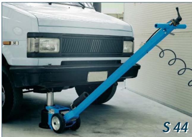
**S 44**: potenza e maneggevolezza sono le caratteristiche principali di questo modello. Il sistema di sollevamento è del tipo a cilindri verticali monostadio. L'escursione di alzata con prolunghe fornite di serie va da 235 mm fino a 605 mm.
